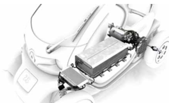
► Disposición del sistema eléctrico
