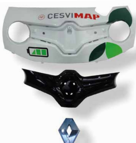
► Despiece del revestimiento delantero superior
