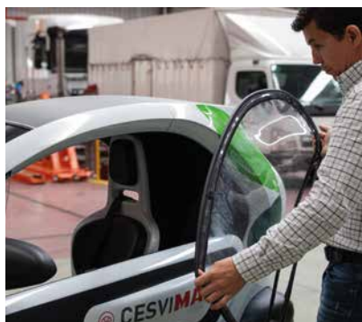
► Colocación del kit de ventanillas
